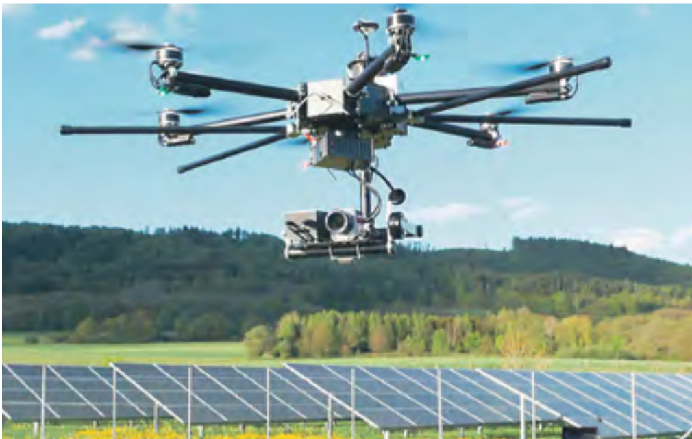
Die Drohne aus Kulmbach wird zur speziellen fliegenden Wärmebild-Kamera. So kann man Schäden an den Solarzellen und sogenannte Hotspots schnell finden.
